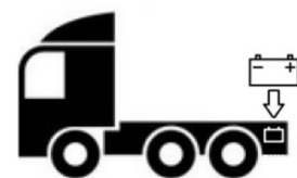
Obrázek 3: Místo instalace baterie na zadní ose
